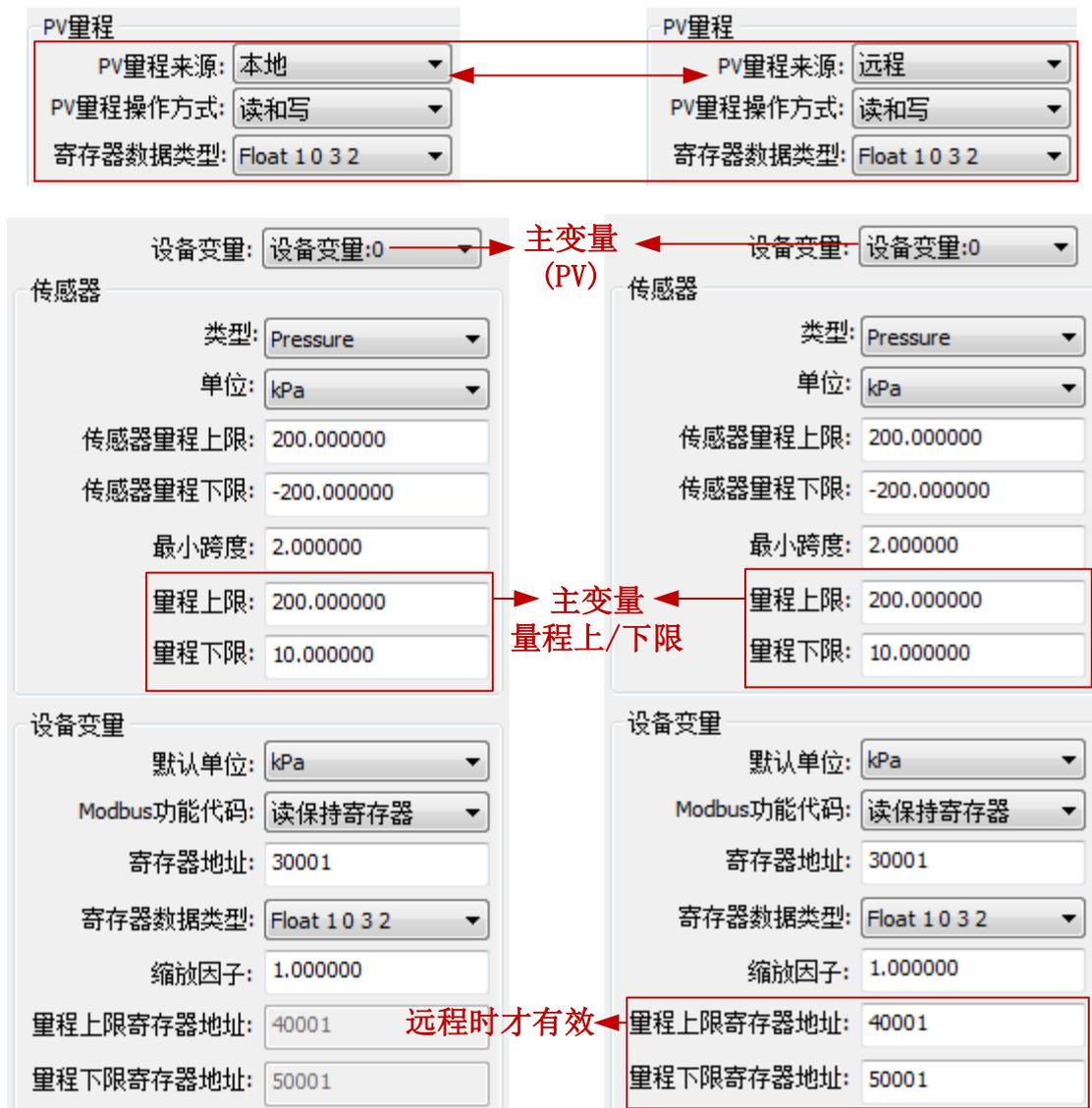
图 3.5 PV 量程操作实例
