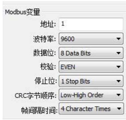
图 2.6 Modbus 通信参数
