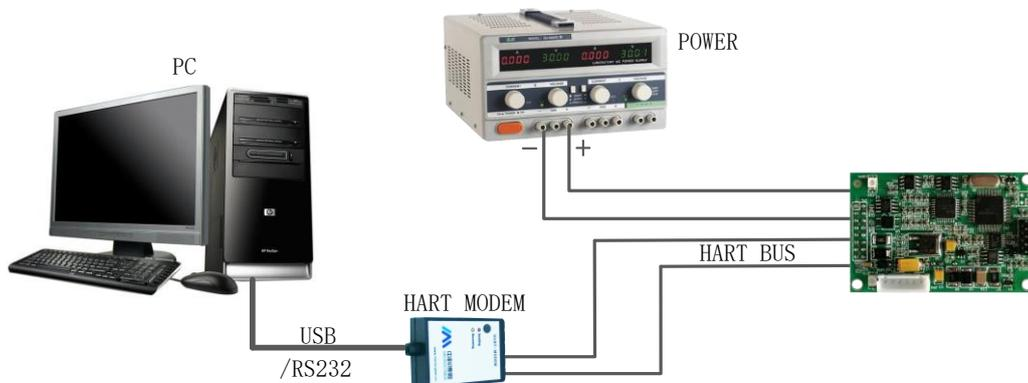
图 1.2 配置 HART 模块接线图
